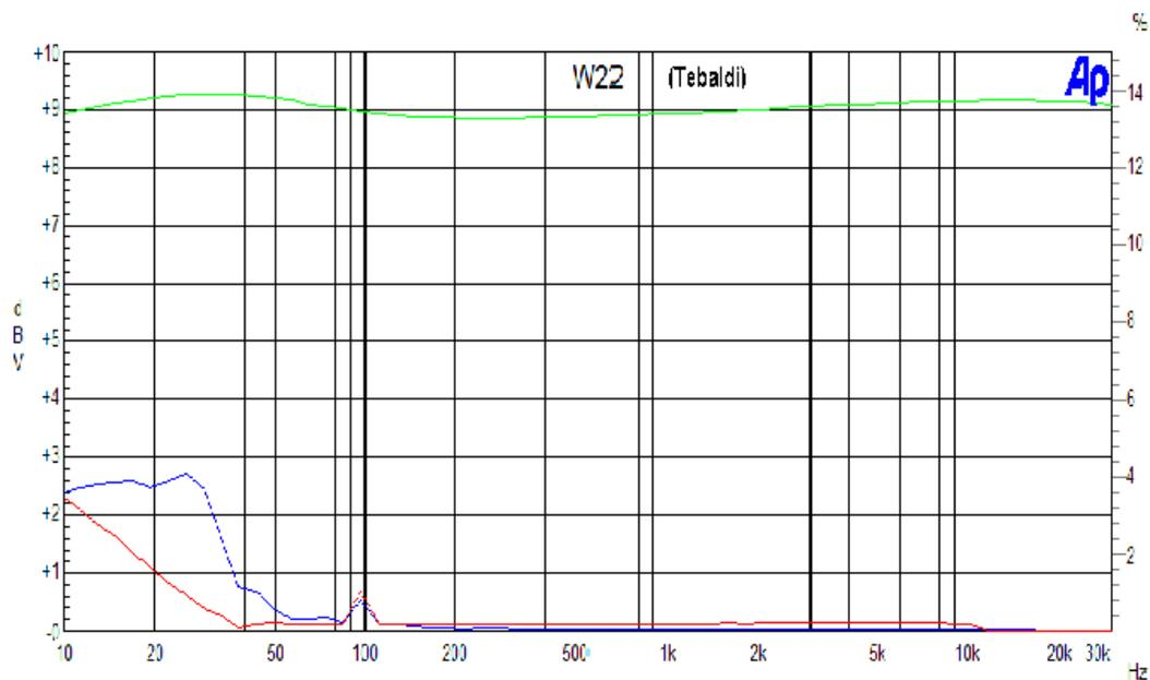
questi due grafici riportano la distorsione di corrente misurata per un woofer L22 "normale" ed il woofer W22 (da questo derivato) con circuito magnetico linearizzato sviluppato per il diffusore mod. Tebaldi. La riduzione della distorsione è evidente.
