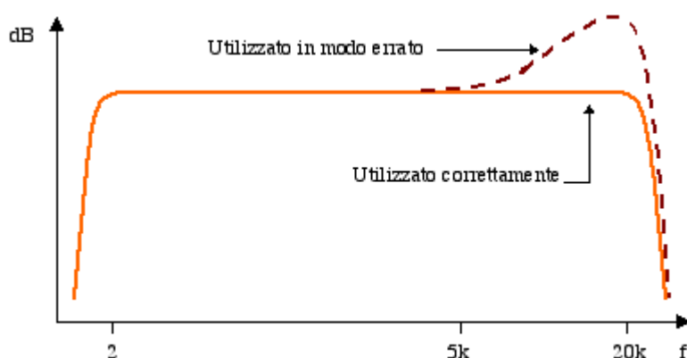
Fig. 5 - Risposta in frequenza per il microfono a campo diffuso
