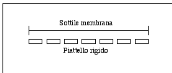
Fig. 6 - Schema del microfono a condensatore
