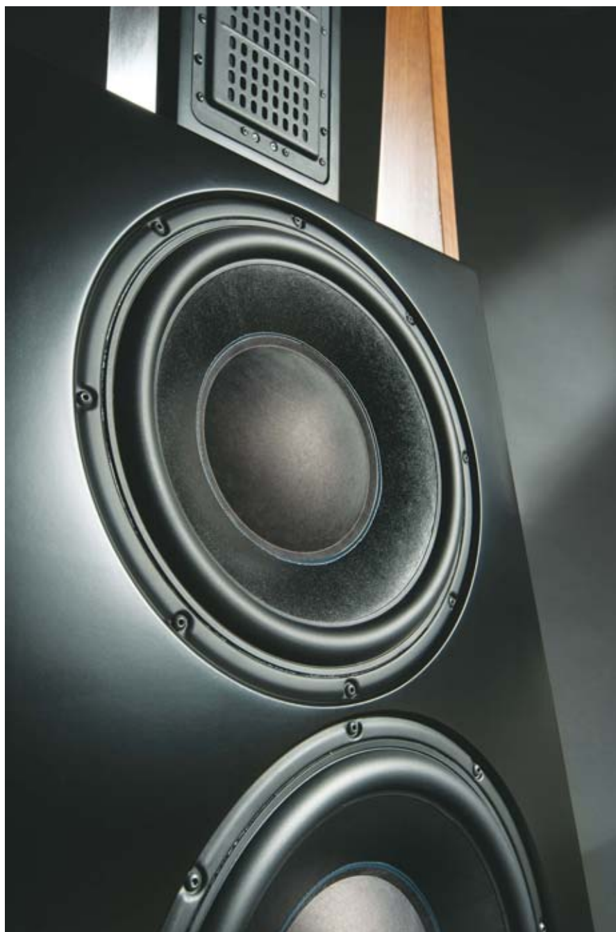
I due woofer sono montati in un unico volume e differiscono per la maggior massa dell'altoparlante inferiore che ottiene così una migliore estensione della risposta in gamma bassa.
