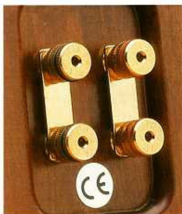
Sul retro spiccano i grossi morsetti a vite placcati in oro per il pilotaggio del sistema in bi-wiring, collegati tra loro per mezzo di barrette metalliche anch'esse ricoperte di materiale pregiato.
