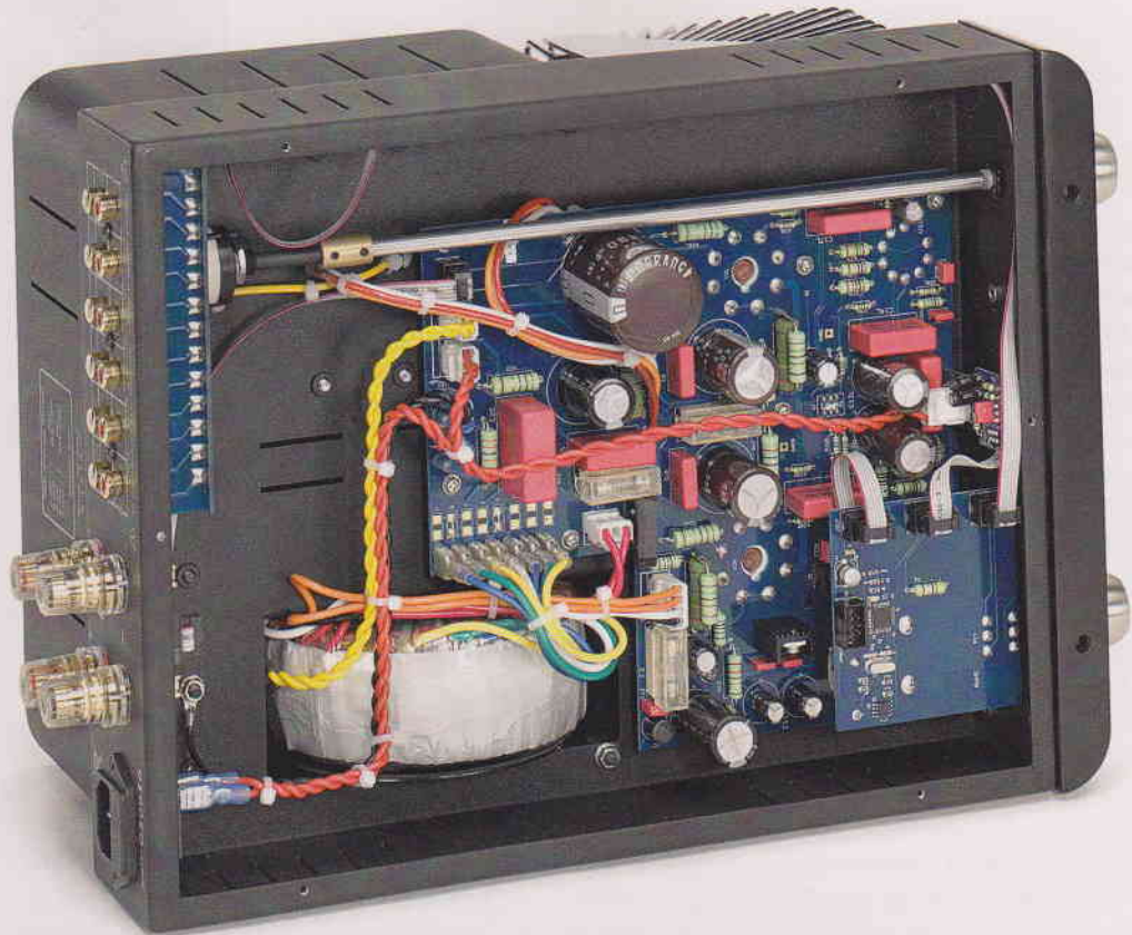
Blitzsauberes Platinenlayout mit üppigem Ringkerntrafo, Elkos und Drossel zur Glättung der gleichgerichteten Spannung. Oben die Achsverbindung zum Quellschalter
