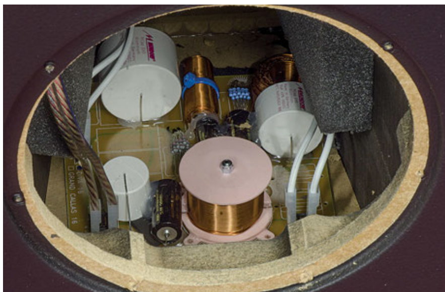
Alla base del diffusore è sistemato il filtro crossover. Notare la qualità dei componenti usati.
