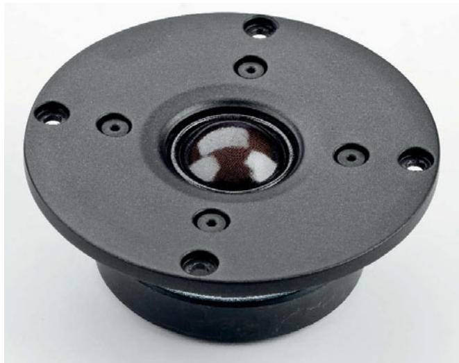
Il tweeter della Scan-Speak ha la cupola morbida da un pollice ed è caratterizzato da una flangia metallica che evita deformazioni in fase di fissaggio. Il doppio anello di ferrite assicura una sensibilità notevole, mentre la particolare scelta della cupola e delle terminazioni polari assicura una risposta regolare ed estesa fino all'ultrasuono. Notevole la dispersione misurata.
