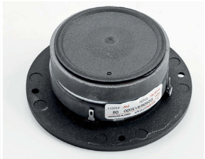
Il tweeter della Scan-Speak ha la cupola morbida da un pollice ed è caratterizzato da una flangia metallica che evita deformazioni in fase di fissaggio. Il doppio anello di ferrite assicura una sensibilità notevole, mentre la particolare scelta della cupola e delle terminazioni polari assicura una risposta regolare ed estesa fino all'ultrasuono. Notevole la dispersione misurata.
