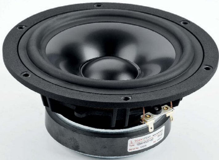
Il trasduttore utilizzato sia per il midrange che per la gamma bassa è stato realizzato grazie ad una sinergia notevole tra la Scan-Speak ed il progettista Mario Bon. La membrana è in alluminio, con la bobina mobile da 39 millimetri ed il motore SD-1 che assicura una eccellente linearità.
