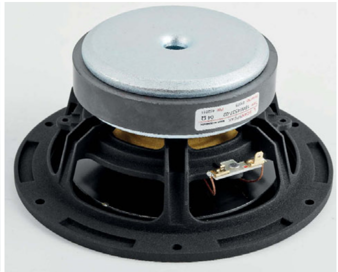
Il trasduttore utilizzato sia per il midrange che per la gamma bassa è stato realizzato grazie ad una sinergia notevole tra la Scan-Speak ed il progettista Mario Bon. La membrana è in alluminio, con la bobina mobile da 39 millimetri ed il motore SD-1 che assicura una eccellente linearità.
