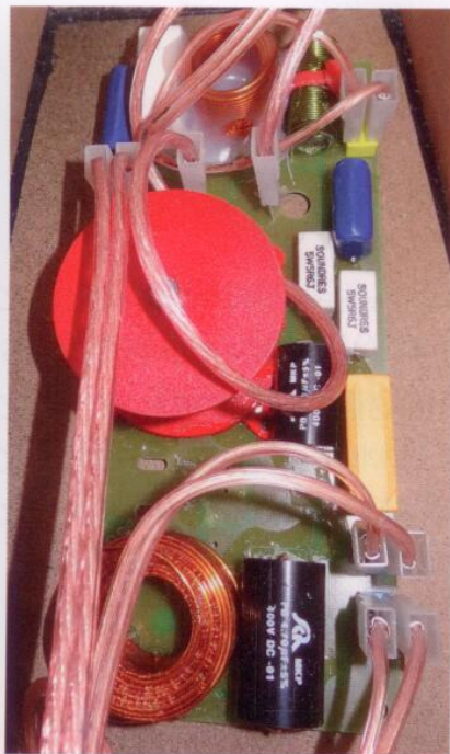
Osat ovat kauttaaltaan laadukkaita. Johdot on kytketty liittimien välityksellä.
