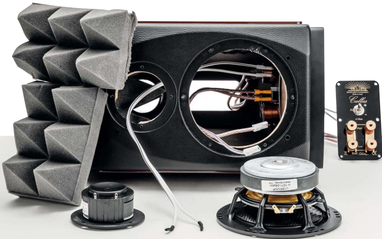
L'esploso del diffusore trevigiano. Notiamo il materiale assorbente bugnato anche se in modeste quantità, la copertura in pelle del pannello frontale e la vaschetta posteriore portacontatti. Il woofer è di costruzione Seas mentre il tweeter è realizzato dalla Scan Speak.
