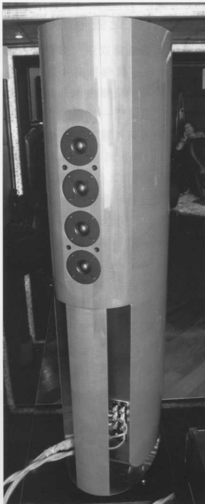
△ Caruso 聲箱背面備有 4 枚取材自上一代旗艦 Tebaldi 的 CLD 後置式輔助高音。
